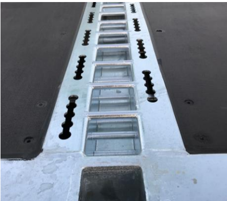
effiziente Elementsicherung durch Rungenrechen (SUVA-geprüft)
